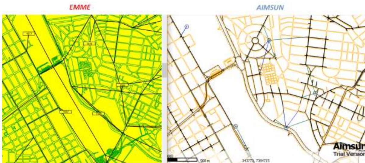
Figura 3: Comparação entre os centroides da Rede EMME com os da Rede AIMSUN
