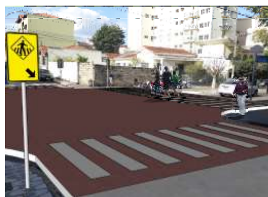
■ Rampa i=10% ■ Piso elevado em intertravado
