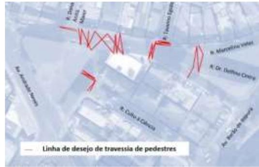
**Figura 11:** Levantamento de linha de desejo de travessia. Fonte: EMDEC
